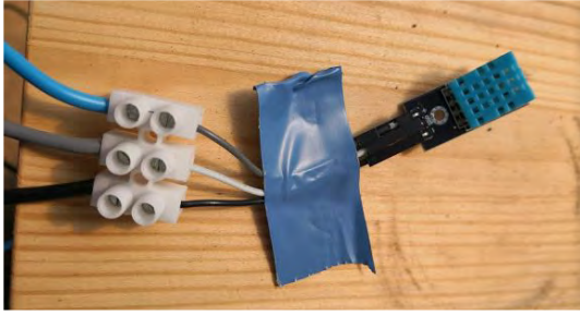
Imatges 3.2.3.3 i 3.2.3.4 - Connexió del sensor DHT11 (Temperatura i humitat ambiental)
