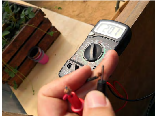
Imatge 3.2.2.10 - Comprobació caiguda de tensió sortida placa solar.
