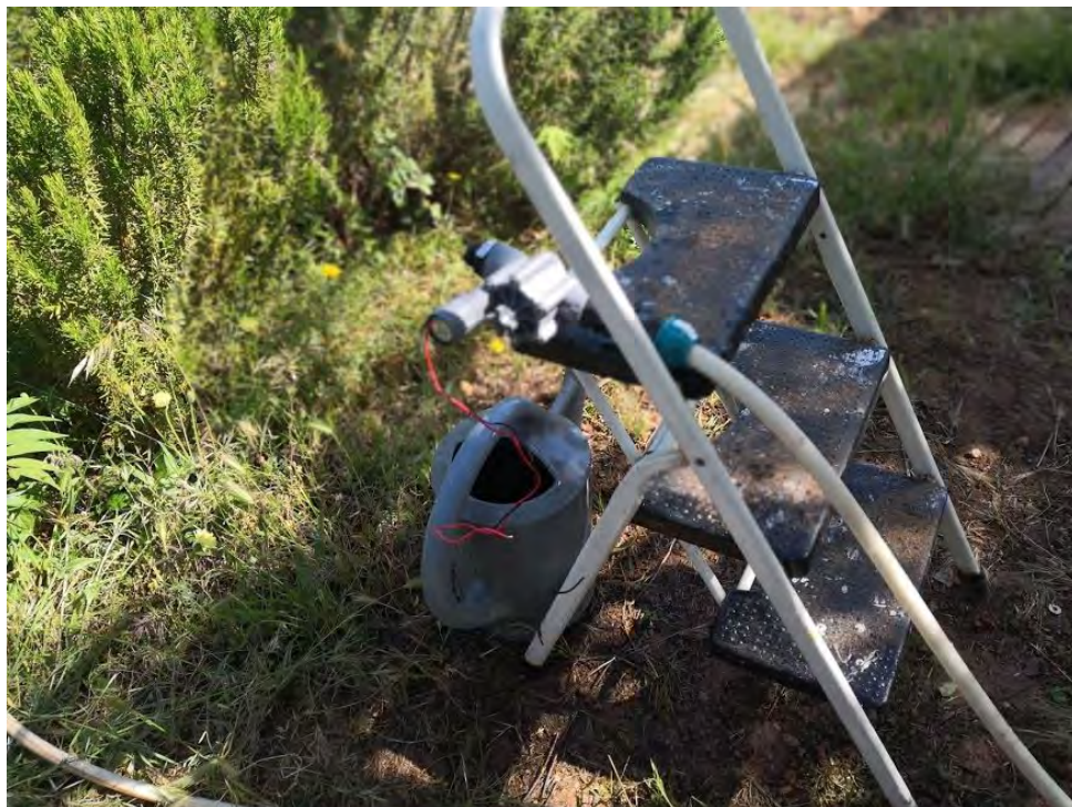
Imatge 6.2.2.3. - Realització de proves amb l'electrovàlvula en entorn real
