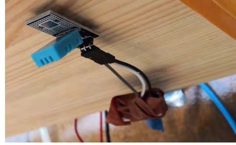
Imatges 3.2.3.3 i 3.2.3.4 - Connexió del sensor DHT11 (Temperatura i humitat ambiental)
