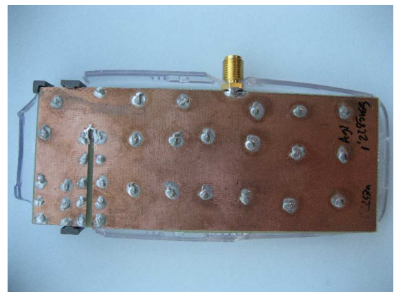
Fig.3. Fotografías del prototipo implementado. Se observa la antena PIFA y el plano de masa ranurado
