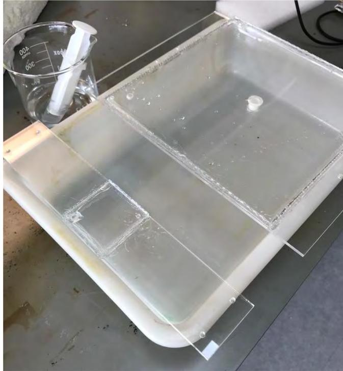
Figura 61 Componentes de la antena microstrip en proceso de secado del adhesivo.
