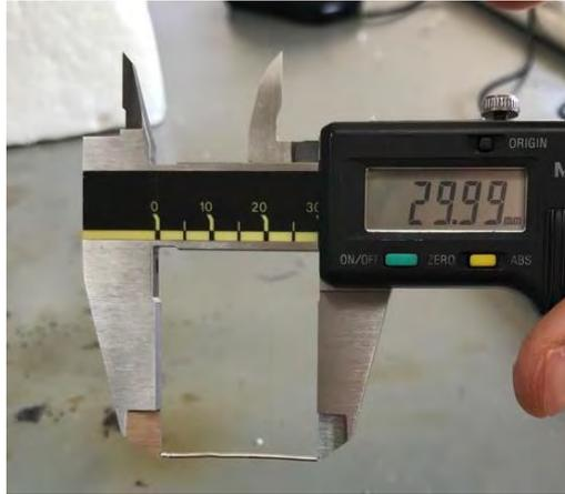
Figura 78 Ejemplo de corte de hilo calibrado para una antena monopolo a la frecuencia centrada de 2.45 GHz (30mm)
