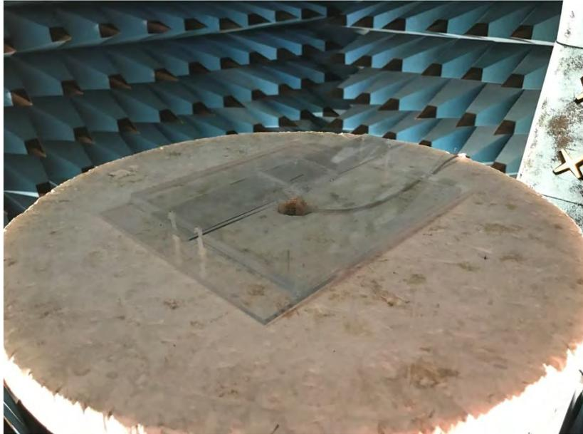
Figura 68 Antena microstrip de agua trabajando en la banda ISM a 2.4-2.5 GHz.
