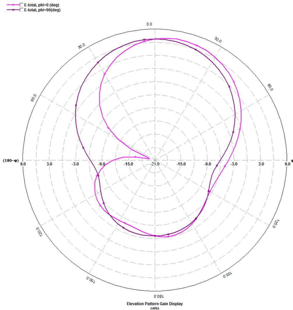
Figura 20 Diagrama de radiación para una antena microstrip con plano de masa de agua y con alimentador por acople capacitivo. PHI = 0 (línea rosa) y PHI = 90 (línea lila).
