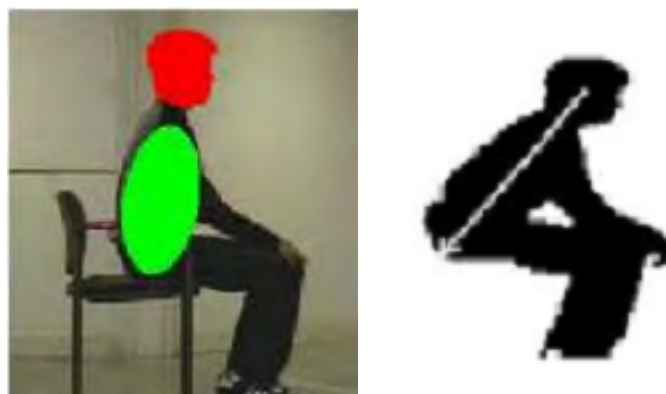
FIGURA 1 A L'ESQUERRA, DETECCIÓ DEL CAP I EL TRONC. A LA DRETA, CONNECTIVAT DES D'EL CAP
