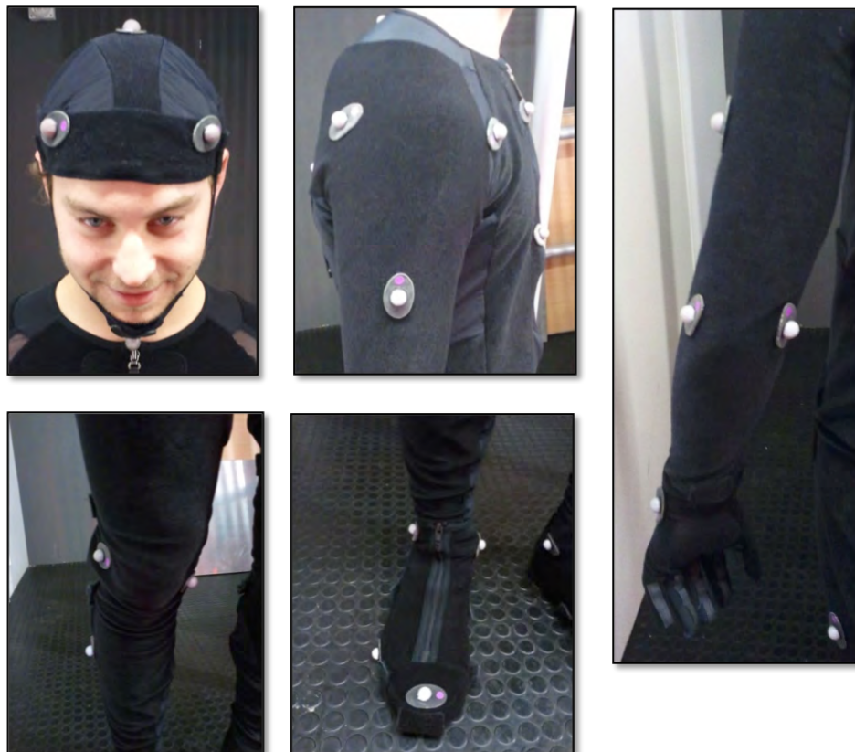
FIGURA 35 DETALL DE LA COL-LOCACIÓ DELS MARCADORS ÒPTICS
