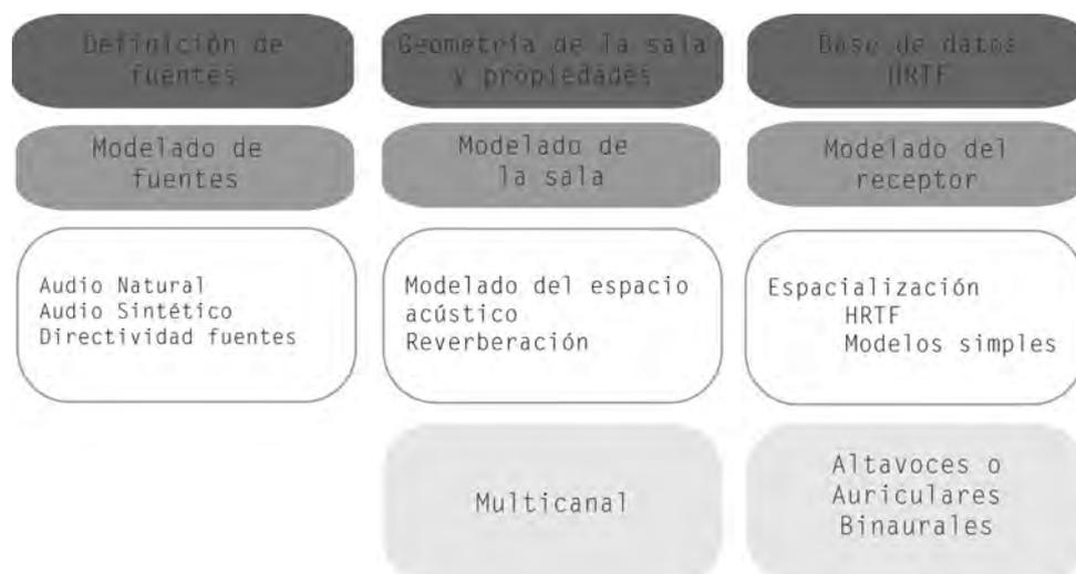
Figura 2.1: Diagrama de un sistema de audio 3D [10]
