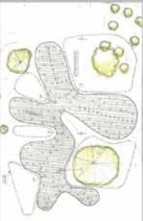
Esquema general de conformación de la planta a través del ensaje de la cubierta entre la copa de los árboles.
