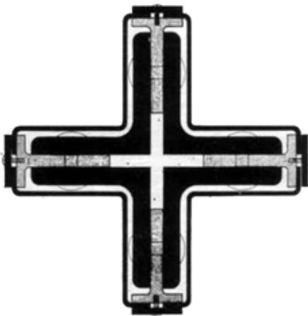
Fig. 24 y 25: Los perfiles de acero se ocultan tras una chapa, evidenciando así su falta de expresión o de belleza frente a materiales nobles como el mármol
