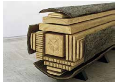
Fig. 15: Las fibras del tronco muestran la edad del mismo e influirán en la resistencia, que irá en función de la dirección en la que se le aplique una fuerza
