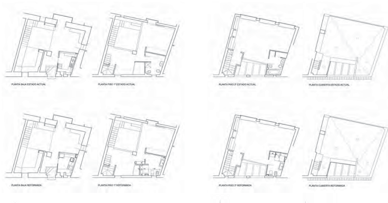
93. Planos Proyecto Reforma de vivienda en edificio entre medianeras. Facilitado por el Arq. Víctor Beltrán Roca.
