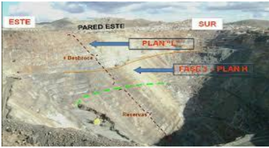
2.29 Vista de un corte del tajo donde se indica las paredes de próxima expansión, colindantes a la ciudad.
