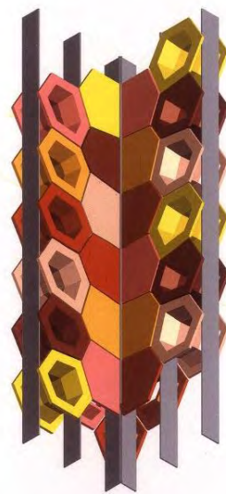
Ilustración 42 Render de piezas en esquina. La vista en planta, vista exterior y vista interior muestran la colocación de las piezas de esquina, hacia el exterior son seguidas de piezas huecas y en su interior están cerradas por piezas planas. (Cumella T. , 2016)
