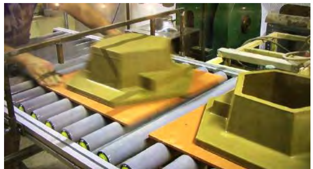
Ilustración 53 Corte de superficie para que el resultado de la pieza sea sin fondo. (Cumella T. , 2016)
