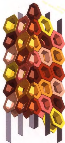
Ilustración 42 Render de piezas en esquina. La vista en planta, vista exterior y vista interior muestran la colocación de las piezas de esquina, hacia el exterior son seguidas de piezas huecas y en su interior están cerradas por piezas planas. (Cumella T. , 2016)
