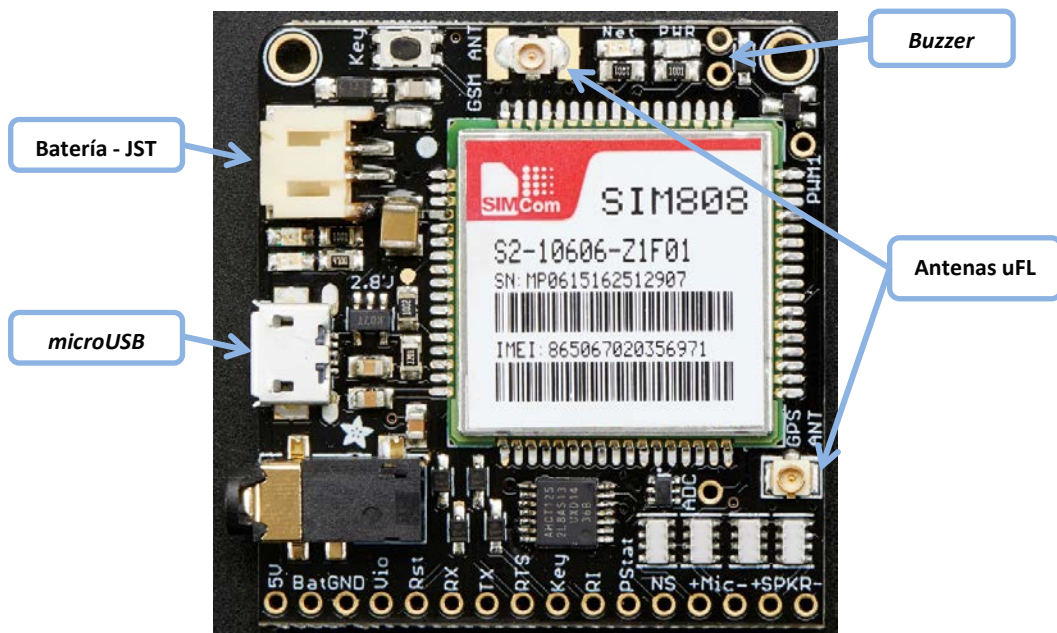
Figura 12. Detalle de pines del módulo GSM+GPS.
