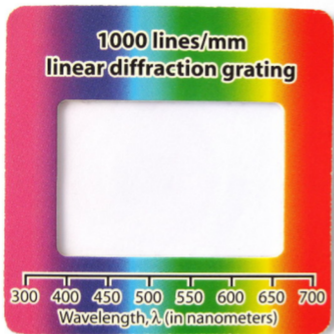
Figura 6: Xarxa de difracció de 1.000 línies per mm, de Ciensación.
