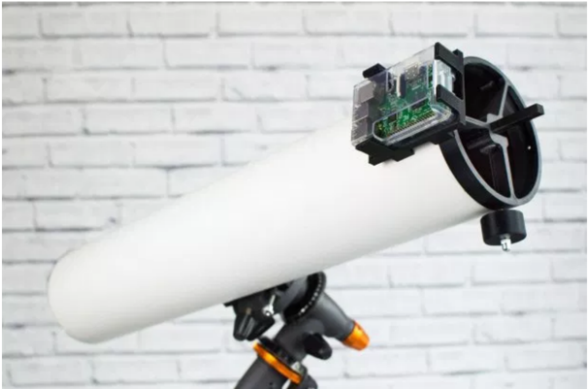
Figura 4: Telescopi Pikon, un model DIY amb peces impreses 3D i una Raspberry Pi.
