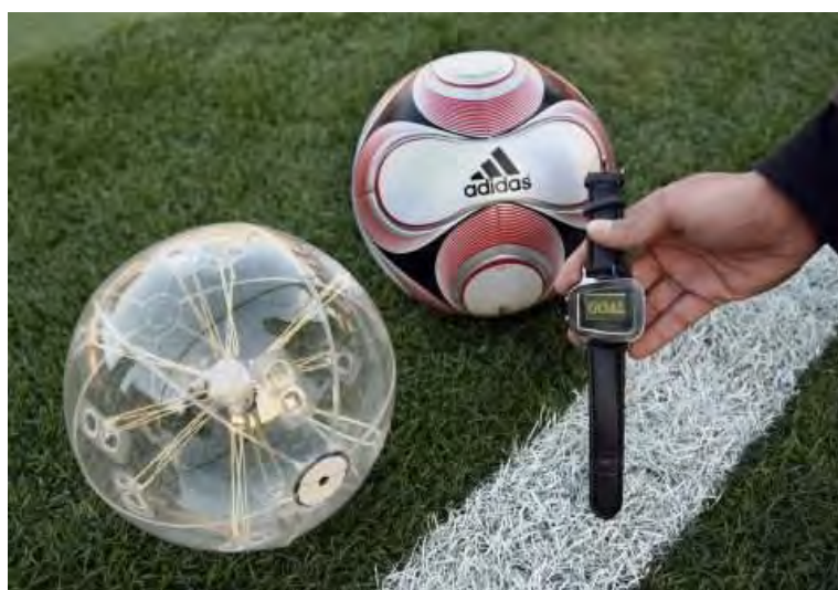
Figura 12. SeFútbol.(2016).Imagen que representa que cuando la pelota atraviesa la línea de meta, aparece gol en el reloj del arbitro.
