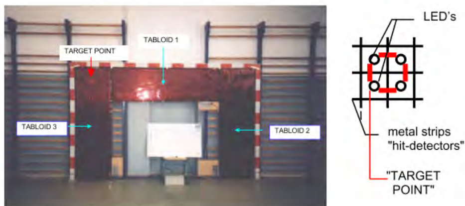
Figura 3.7 - Part del dispositiu electrònic per mesurar la precisió del llançament en handbol. Font: Ioannis; Bayios et al., 1998.
