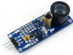
Figura 4.10- Làser utilitzat de la marca Waveshare amb emissor i receptor. Font: elaboració pròpia
