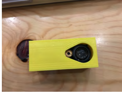
Figura 5.9 - Detall de la protecció del làser. Font: Elaboració pròpia.
