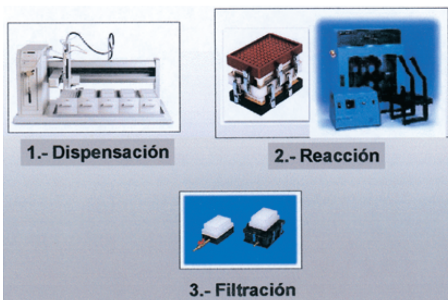
Figura 4. Sistema modular compuesto por Robot Gilson 215 de Gilson® y sistema FlexChem de Robbins® disponible en el Grup d'Enginyeria Molecular.
